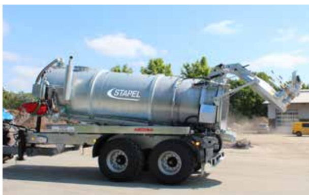
Vakuumfass mit komplett öffnenden Deckel, zum Kippen.
