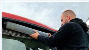
Einfach: Kabinenfilter ohne Werkzeug aus-/einzubauen.
