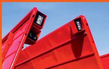
Ser. LED Rücklichter oben in den Bordwänden integriert.
