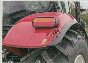
Hubwerk, Zapfwelle und ein Ventil sind extern zu bedienen.
