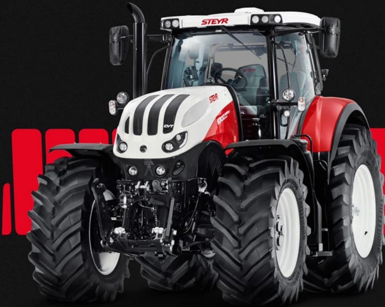
**2 Modelle mit 271 und 300 PS Nennleistung und stufenlosem CVT-Doppelkupplungsgetriebe.**
