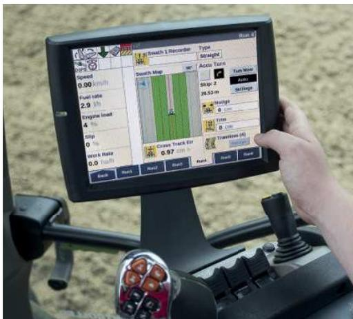
Eine wichtige neue Entwicklung, die Case IH auf der SIMA vorgestellt hat, ist AccuTurn. Ein Paket für die AccuGuide-Lenkautomatik, das die Wendevorgänge am Vorgewende automatisiert und den Traktor mit hoher Genauigkeit in die nächstgewählte Fahrspur einfädelt. Auf Knopfdruck eingeschaltet, übernimmt AccuTurn die Steuerung des Wendens am Ende des Feldes und steuert sauber und präzise in die nächste Fahrspur.
