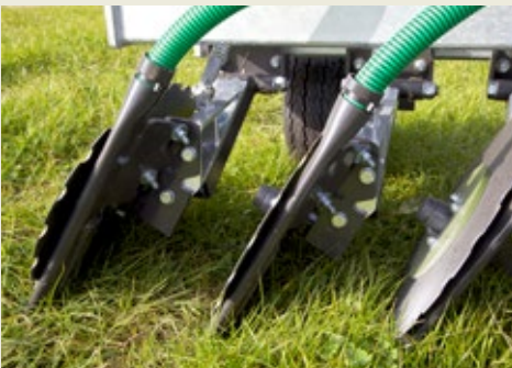
Stufenlose Einstellung der Scheiben
