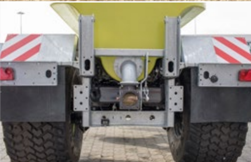
Anbaukonsole für Schleppschuhverteiler und Vierpunkthydraulik
